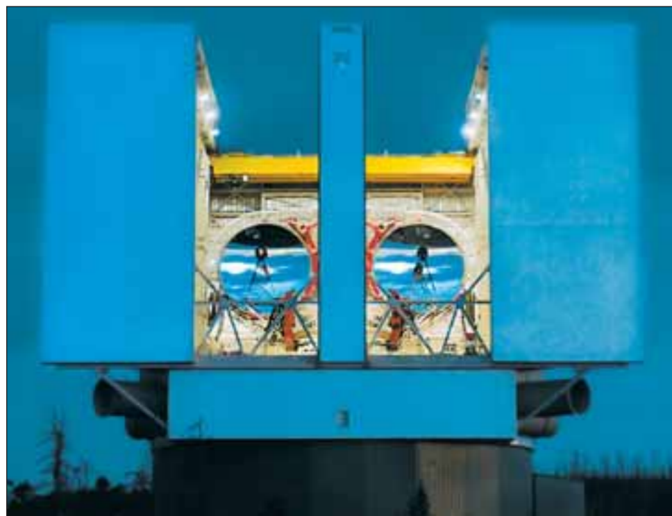
Large Binocular Telescope (LBT) in Arizona: Die beiden Spiegel mit je 8,4m Durchmesser wirken gemeinsam wie ein Teleskop mit 12 Meter Spiegel Durchmesser. Die Position der beiden Teleskope ist so gewählt, dass sich der Abendhimmel darin spiegelt. Foto: LBT
